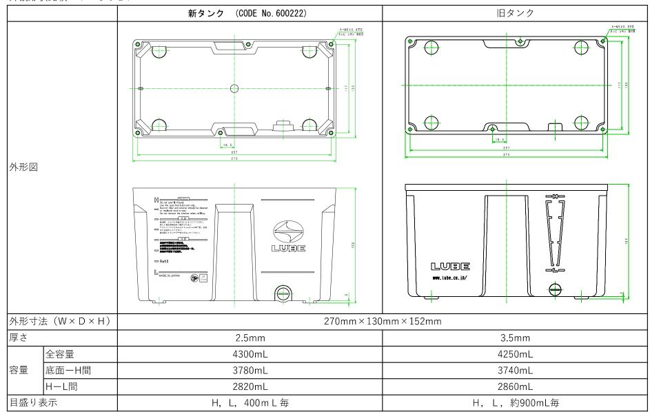
ポンプ銘板貼り付けからタンク印刷への変更(例; AMZIIIポンプ)
